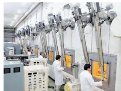
遠隔操作による放射性材料の調査・試験風景
