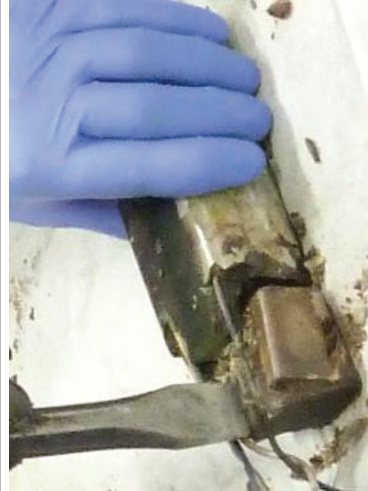
工具によりコンパウンド樹脂を剥離
