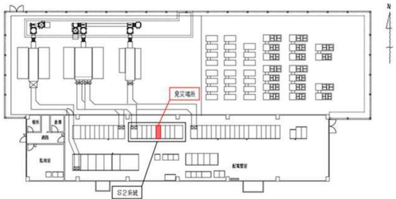
図3 50GeV 変電所内の高圧配電盤の設置
