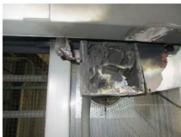
図4 焼損した電源ケーブル収納ボックス (左：外観、右：蓋を開けた内部の様子)
