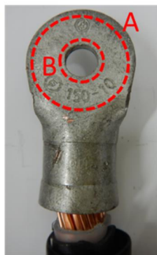
他の正常圧着端子
