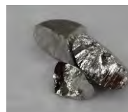
合成に成功した新物質 \text{Mn}_3\text{RhSi} の多結晶体(左上)
