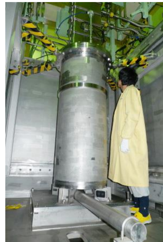
STACY炉心タンク (直径60cm、高さ150 cm)
