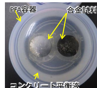
模擬デブリの 水中での溶出試験
