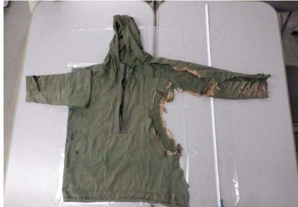
耐火服焼損状況
