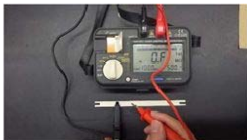
抵抗試験（乾燥状態）O.F. = 2000MΩ以上
