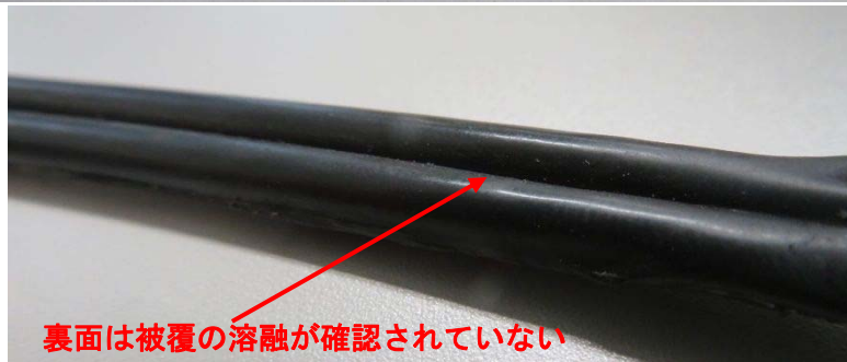
当該電線管に溶着していたと推定される箇所
