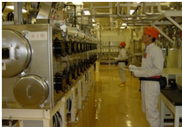
未照射MOX溶解試験を行う CPFのグローブボックス
