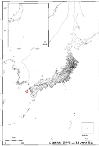
全国の地殻変動(水平)－1ヶ月－ 基準期間：2011.06.21～2011.06.27〔F3:最終解〕 比較期間：2011.07.21～2011.07.27〔R3:速報解〕
