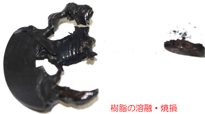
図2-3 プラグのカバー樹脂の状況
