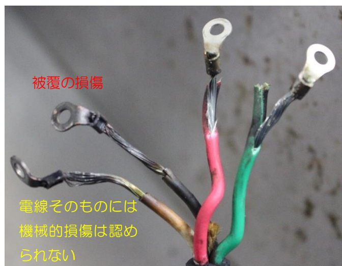
図 2-7 プラグ内部の電極に接続する配線
