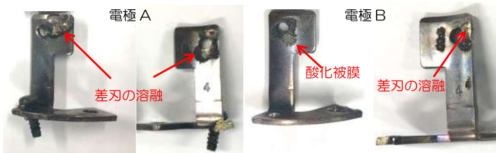
図 2-5 プラグ電極のコンセントと接触する部分の状態
