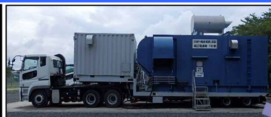
空冷式発電機からの電源供給
