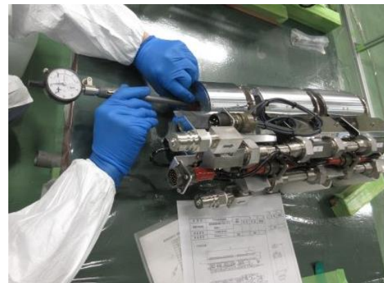
可動コイルの更新の様子
