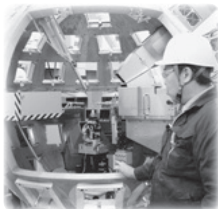
茨城県生物物質構造解析装置。この装置でタンパク質の解析等が行われます。
