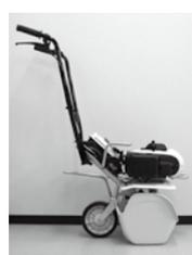
燃料はカセットコンロのガスボンベで、燃料補給の手間や危険性を低減できます。また、二酸化炭素の排出量も少ないため、人にも環境にも優しい管理機です。小型で軽量なため扱いやすく、家用車への積載も可能です。ぜひご利用ください。
