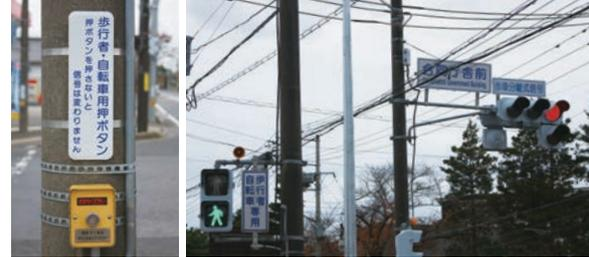
歩行者の横断と車両の通過が交わらないように、青信号の時間を分離している「歩車分離式信号機」。これは、横断中の歩行者と右左折中の車両との衝突事故を防止し、歩行者の安全を最優先に配慮するために設置されるものです。現在、村内の5か所に押しボタン式の歩車分離式信号機が設置されています。横断や通過の際の注意点をご紹介します。
