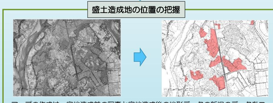
マップの作成は、宅地造成前の写真と宅地造成後の地形データの新旧のデータをコンピュータ上で重ね合わせ、造成後の高さや勾配、面積がガイドラインで該当するものに対して抽出します。
