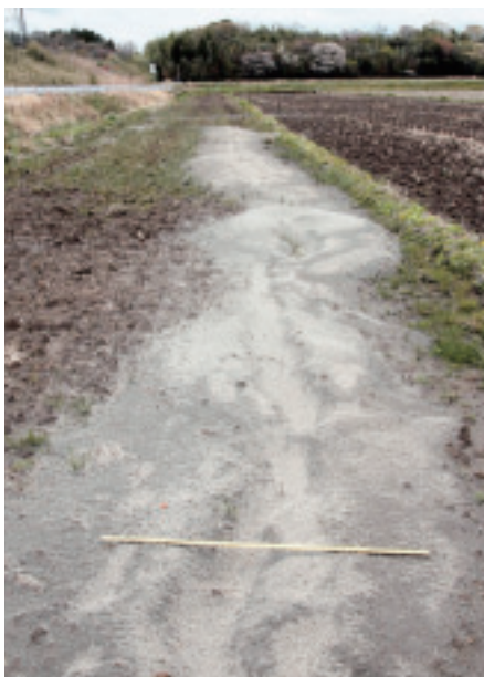
液状化で水田に噴出した地下の砂(白色部)＝石神内宿沖田
